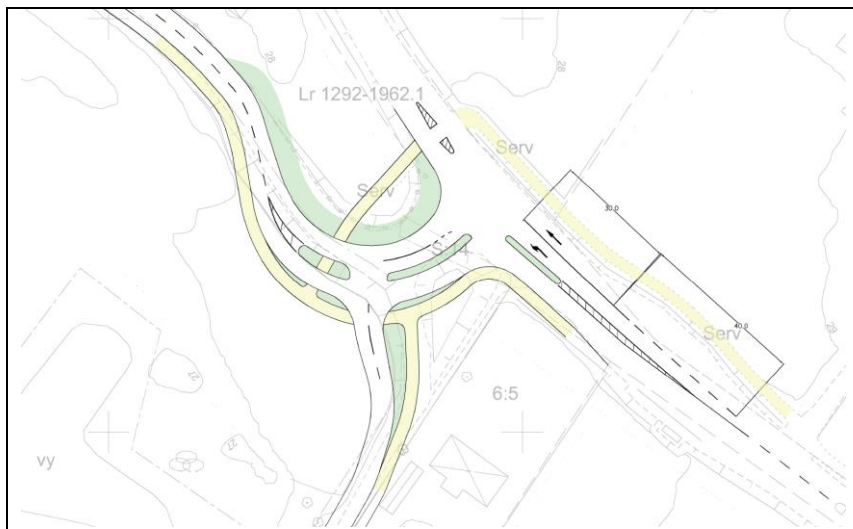
Figur 5 Principutformning av de två korsningarna vid väg 1710
