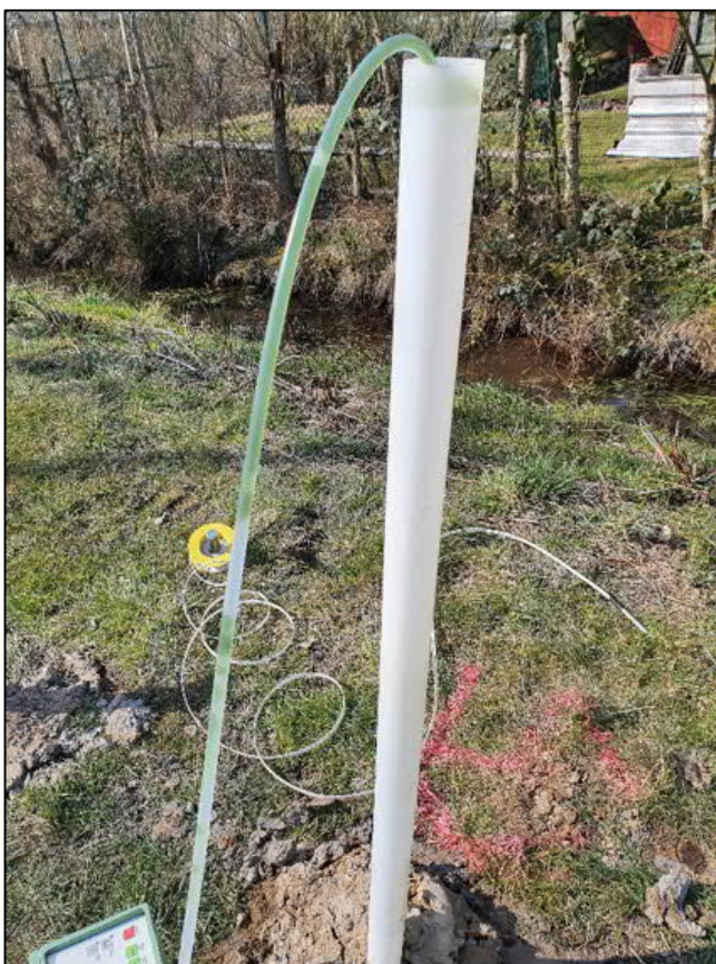
Figur 3. Grundvattenrör 20T05. På bilden syns den grönfärgade vätskan i slangen vid provtagningen 2020-03-30-
