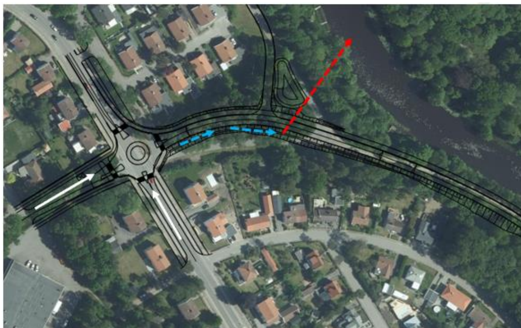
Figur 9 Förprojekterad sträckning för Klippanvägens förlängning. Vita pilar markerar flöden från Stationsområdet. Blå pilar markerar föreslagen avrinningsväg i planerat dike, röd pil markerar ungefärligt läge på föreslagen kulvert.
