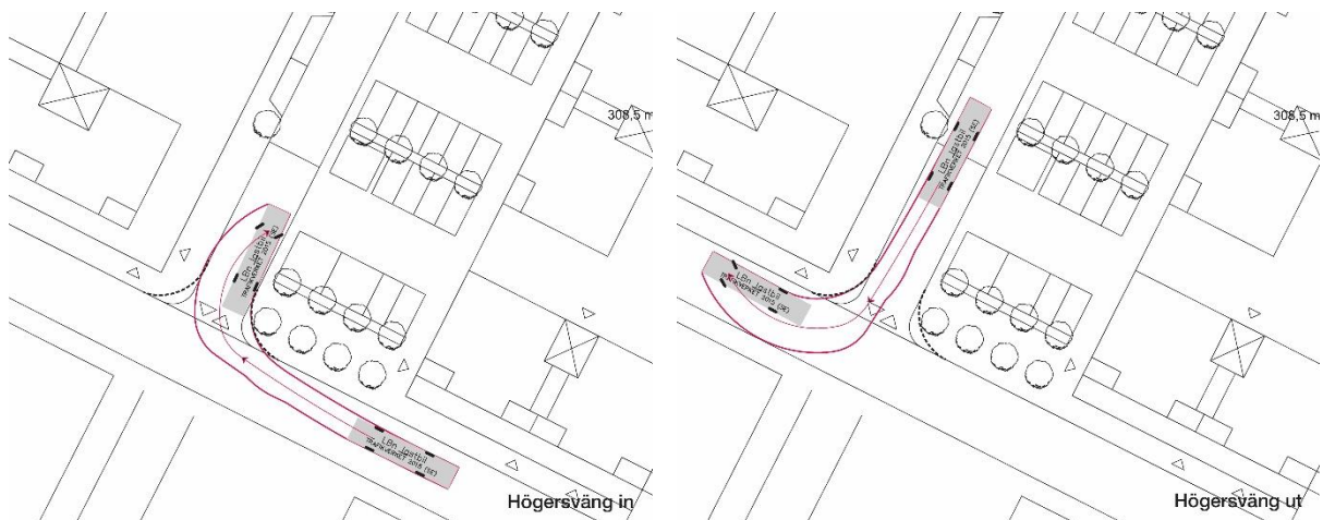
Figur 7 Resultat från körspårsanalys för LBN i den nya anslutningen till den utökade livsmedelsbutiken. Radie för streckad linje är 5,5 m.
