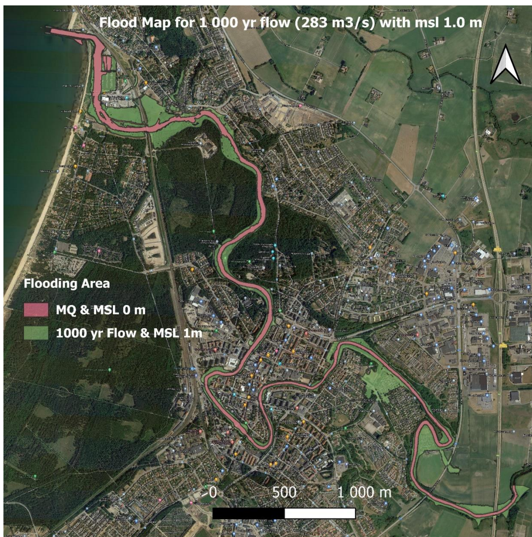
Figur 10 Översvämningsutbredning vid ett 1000-årsflöde med vattennivå +1,0 m (RH2000) i Skälderviken. Rosa fält visar vattenytan vid medelflöde.
