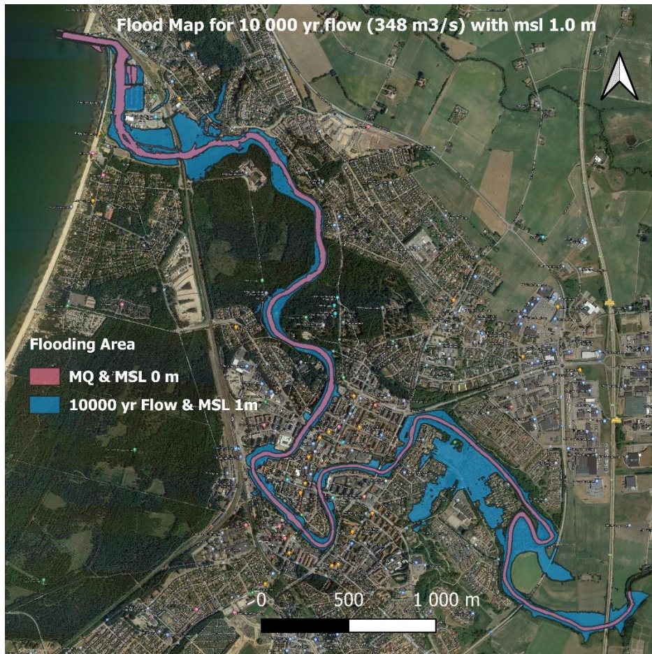
Figur 13 Översvämningsutbredning vid ett 10 000-årsflöde med vattennivå +1,0 m (RH2000) i Skälderviken. Rosa fält visar vattenytan vid medelflöde.
