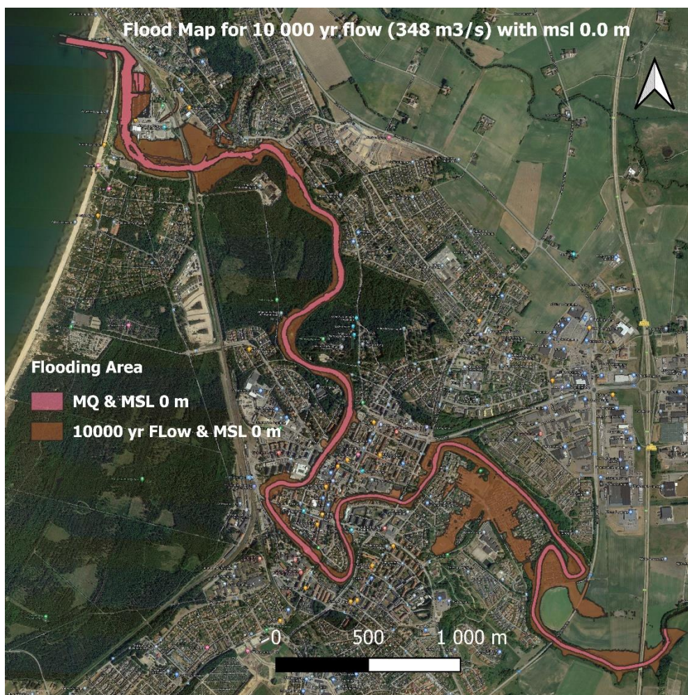
Figur 12 Översvämningsutbredning vid ett 10 000-årsflöde med vattennivå +0,0 m (RH2000) i Skälderviken. Rosa fält visar vattenytan vid medelflöde.
