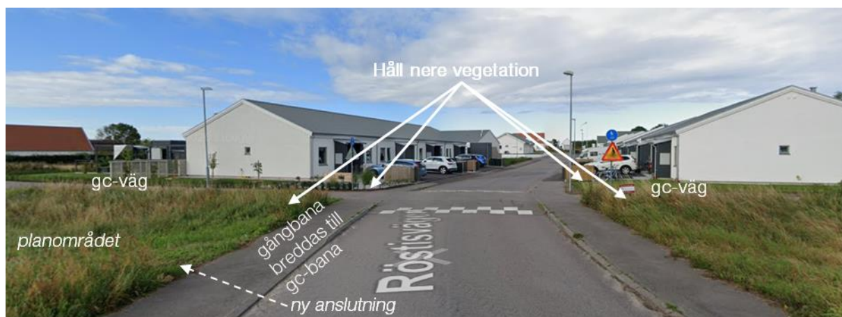
Figur 10 Fri sikt ska uppnås vid gång- och cykelpassagen över Röstisvägen och vegetation ska hållas nere. Befintlig gångbana breddas till gc-bana. (foto från google streetview)
