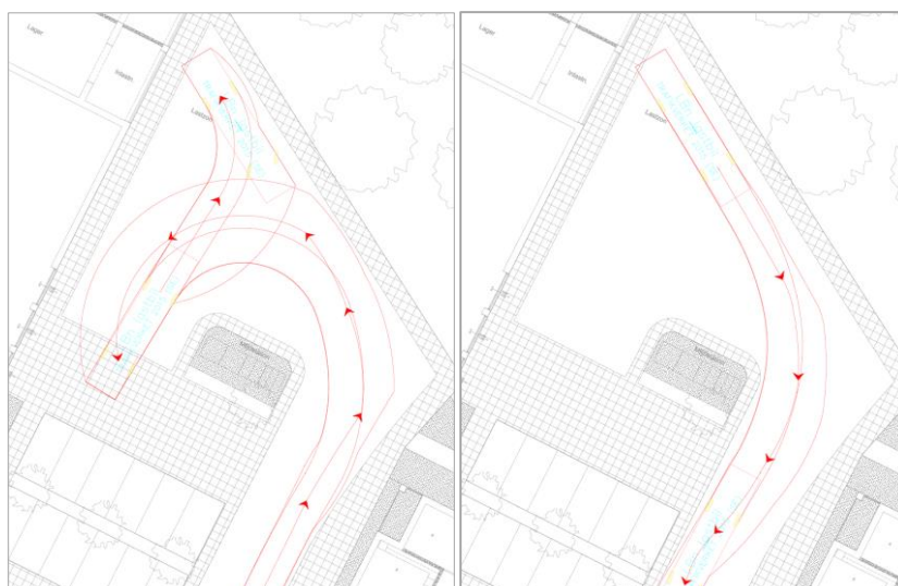
Figur 3 In- respektive utkörning till den norra lastplatsen. Då gränsen mellan asfalts- och plattytan är överkörningsbar kan leveranserna vända för att backa in till lastplatsen.
