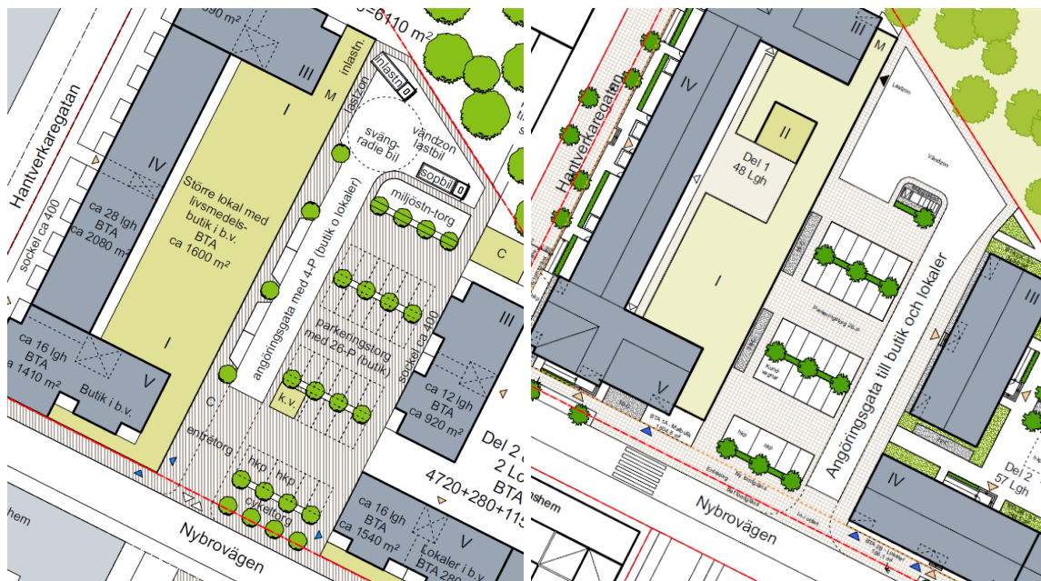
Figur 1 Illustrationsplan för utökad livsmedelsbutik med tillhörande angöringsgata och parkering. T.v tidigare förslag till utformning. T.h nytt förslag till utformning som studeras i denna utredning.
