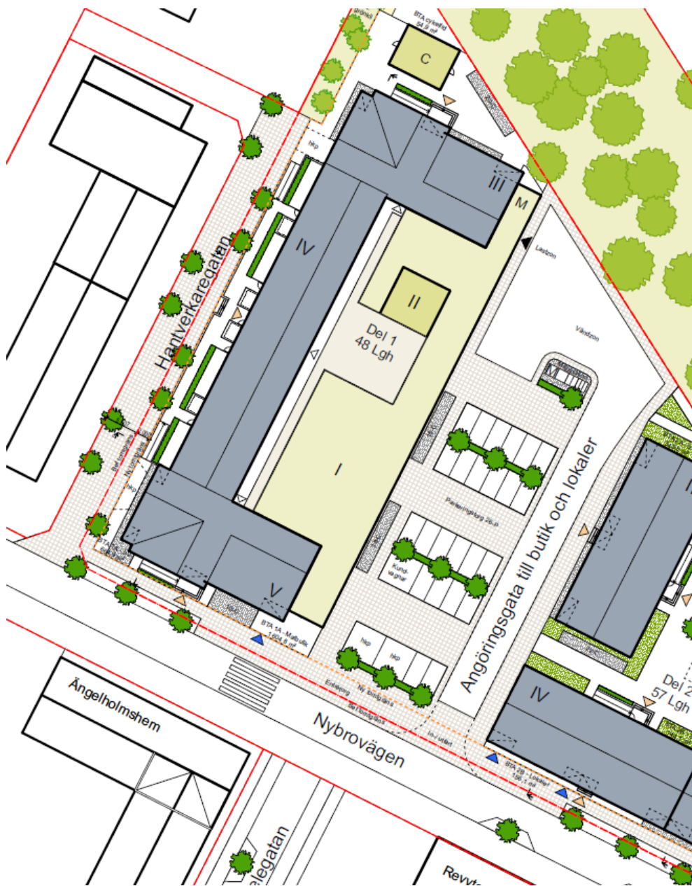
Figur 2 Nytt förslag till utformning av angöringsgata, parkering och vändzon vid den utökade livsmedelsbutiken. Vit yta avser asfalt och rutig avser plattor, det är ingen höjdskillnad dem emellan.
