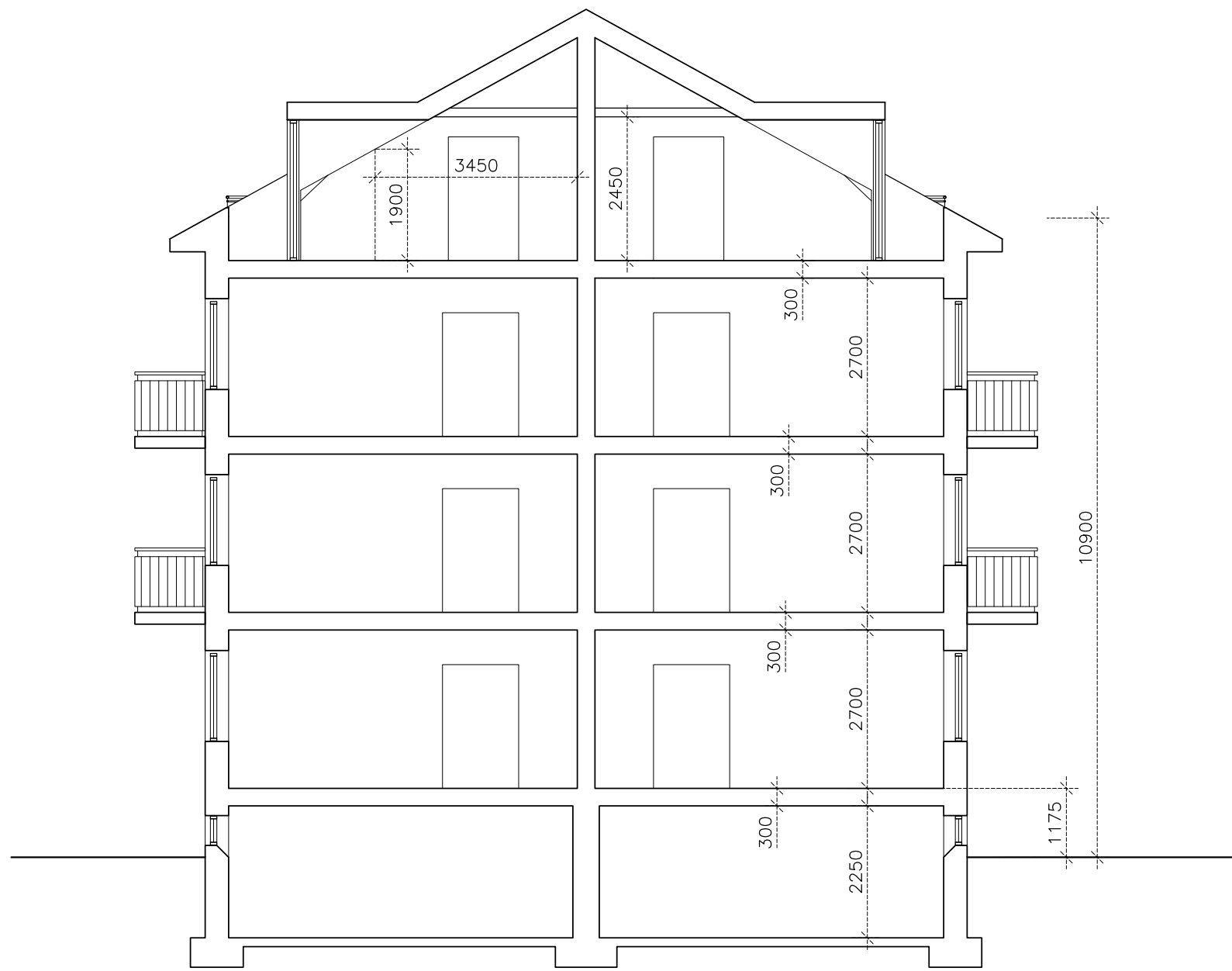
Sektion A-A, BEF BYGGNAD MED BEF KUPOR
