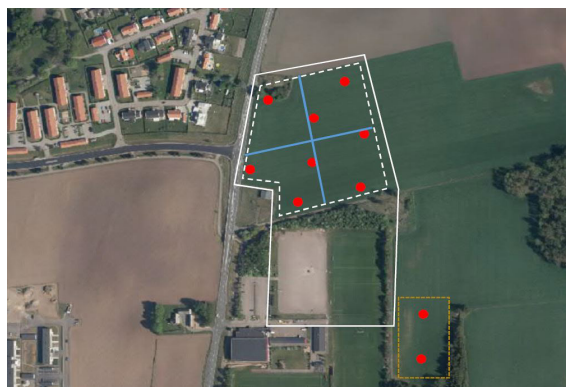
Fig. 4. Borrhovtagningarna i den geotekniska utredningen
