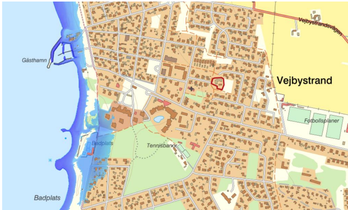
Figur 7 Skärmlapp från SCALGO Live som visar översvämningsutbredning vid +4 meter över havet. Detaljplaneområdet är markerat med rött.
