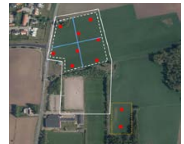
Fig. 4. Borrhöjningarna i den geotekniska utredningen
