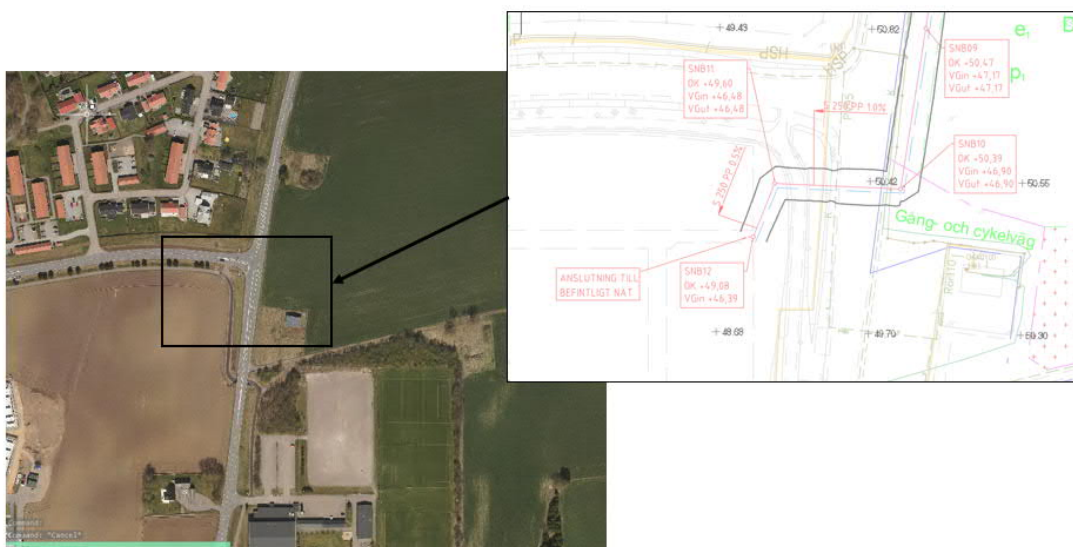
Figur 1. Anslutning till befintligt va-nät. (Google maps 2021-02-24)
