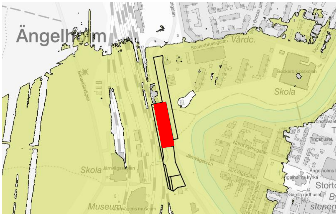
Figur 1 Översvämningsutbredning (gult område) vid simulerat BHF, resultat erhållet från LTHs modell (Mohamed, 2021). Detaljplaneområdet visas med svarta markeringar och inom röd markering planeras busstorget.
