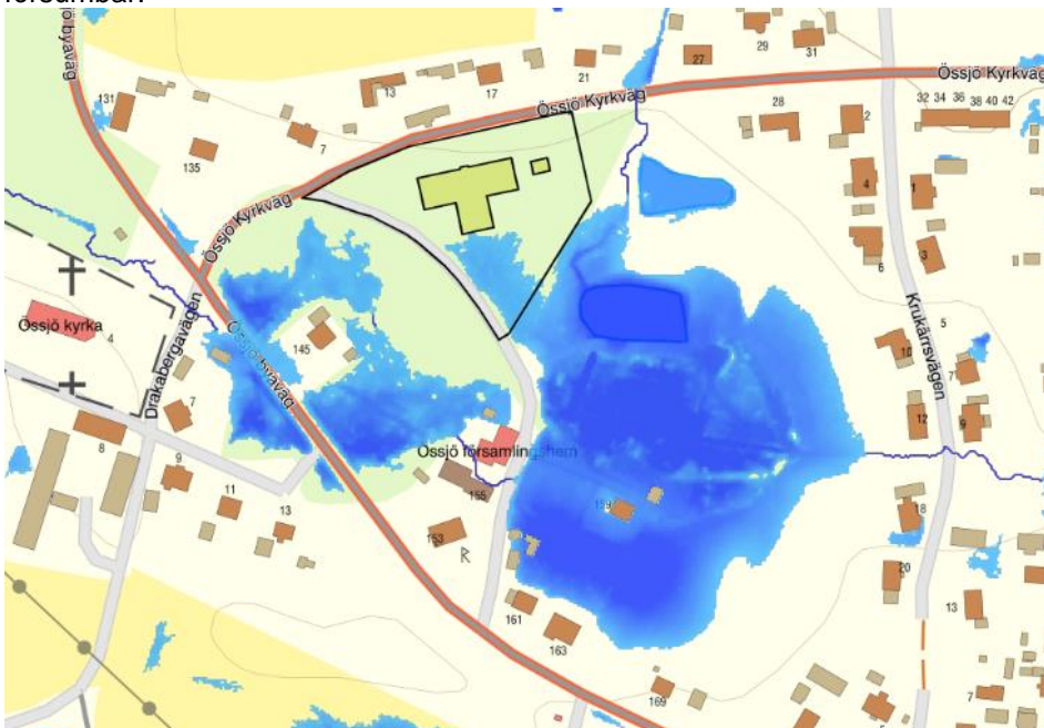
Figur 5. Planerad exploatering (markerad med gul polygon) i förhållande till översvämningsutbredning (blåa fält) vid befintliga förhållanden. Skärmbild från Scalgo Live.
