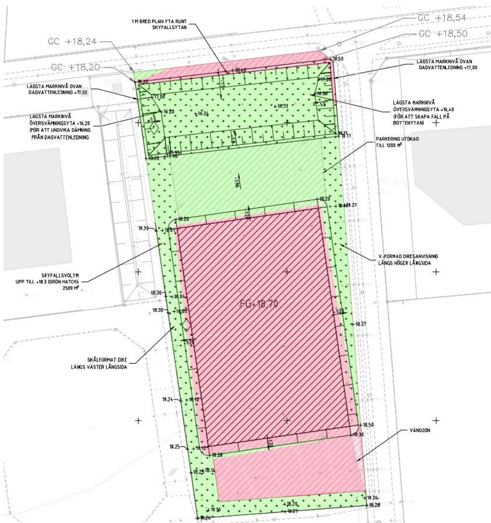
Figur 1. Framtagen höjdsättning för del av Rebbelberga 130:1
