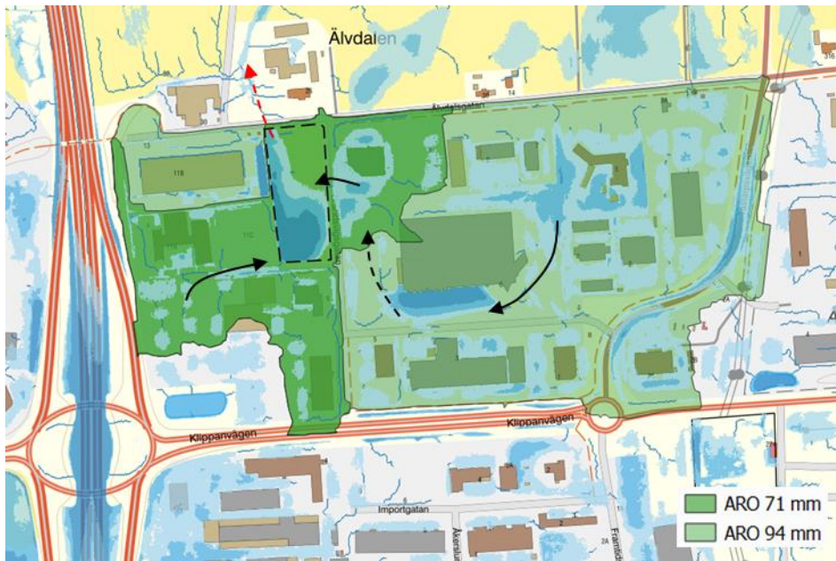
Figur 3. Avrinningsområde vid 68 mm visas i mörkgrönt. Område som bidrar med avrinning vid större regn när lågpunkterna har fyllts upp visas med ljusgrönt. Svarta pilar markerar avrinningsriktning (streckade svart visar avrinningsriktning vid större regnhändelser). Röd pil visar avrinningsriktning då lågpunkten inom planområdet är fylld.
