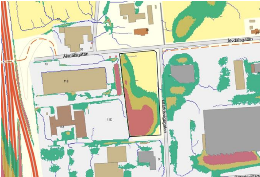
Figur 4. Översvämningsutbredning och vattendjup vid 68 mm. Gröna fält visar vattendjup upp till 20 cm, gula fält 20 – 50 cm och röda fält vattendjup över 50 cm.
