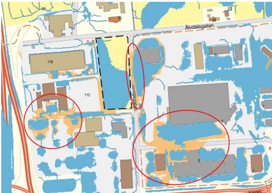
Figur 7. Översvämningsutbredning vid 68 mm för nuläge samt med höjd marknivå inom planområdet. Översvämningsutbredning vid nuläge visas i blått, och översvämningsutbredning efter höjd mark visas med orange.
